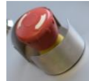
Nödstopp på manöverpanelen
