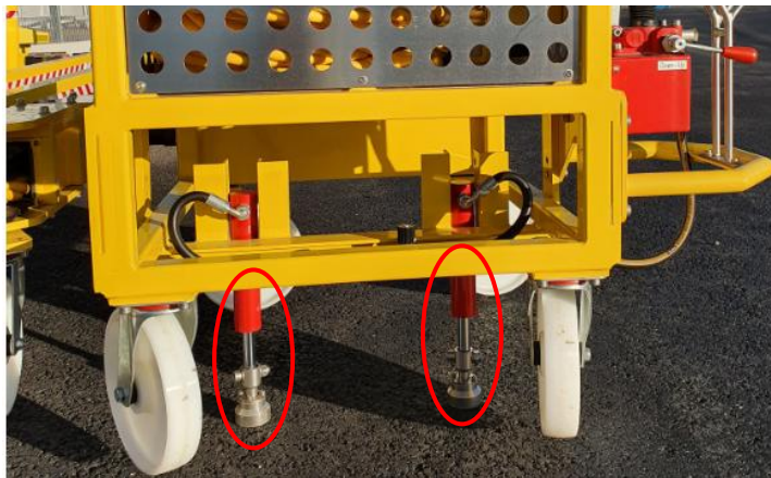
Stödbenen som lyfter kabelkorgen
