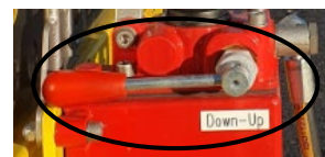
Sänk kabelkorgen med Down
