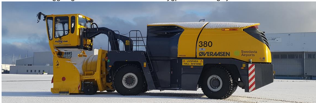
Foto på flygplatsens självgående snöslunga som har till uppgift att slunga snö ut på stråkytor på manöverområdet.
