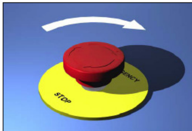
Figur 11: Återställande av nödstoppknapp
