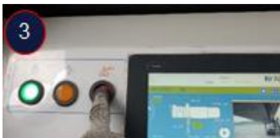
3. Återställ nödstoppet på röd knapp, håll inne tills det piper, ca 5 sekunder
